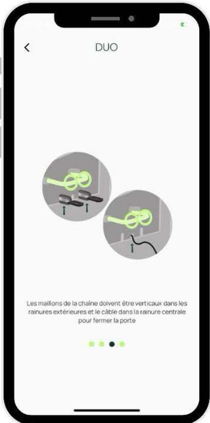
Les maillons de la chaîne doivent être verticaux dans les rainures extérieures et le câble dans la rainure centrale pour fermer la porte
