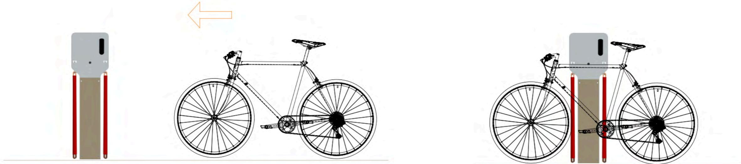
**Etape 2/3 :** Ouvrir la porte du casier, faire passer la chaîne par la roue avant et le cadre. Puis accrocher l'extrémité de la chaîne au crochet prévu dans le casier
